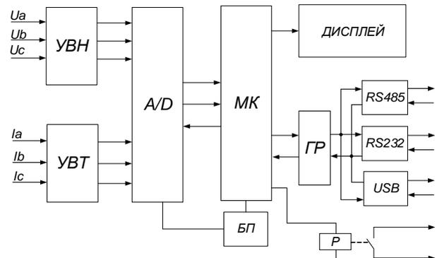
**Рисунок 1 - Структурная схема устройства контроля изоляции конденсаторного типа**
