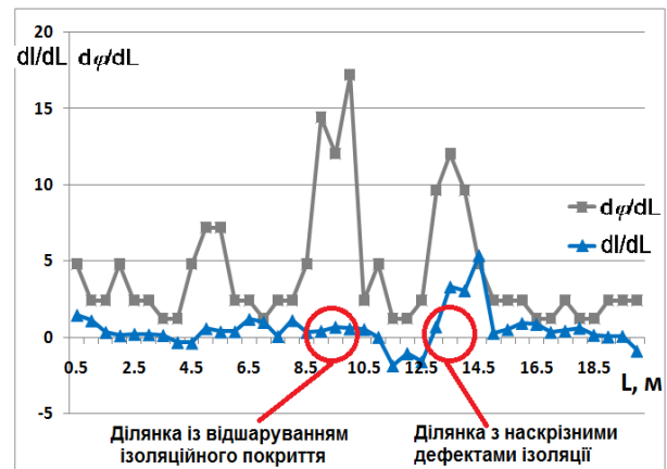
Рисунок 6 – Зіставлені результати вимірювань питомих змін значень струму та питомого зсуву фази на ділянці підземного трубопроводу з різними дефектами ізоляції
