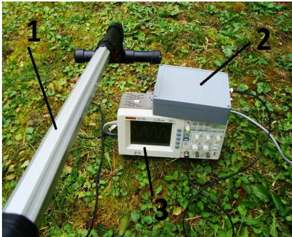
1 – магнітна антена; 2 – вимірювальний блок; 3 – цифровий двоканальний осцилограф
