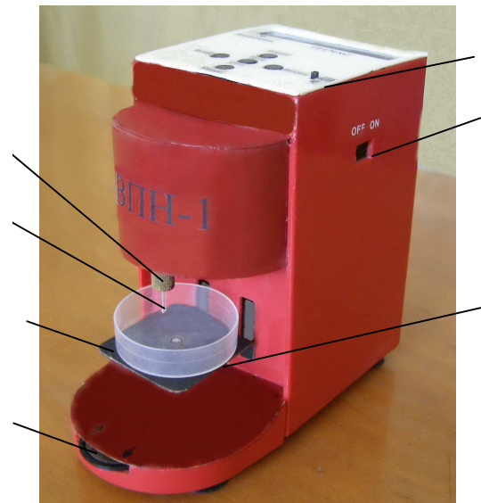
1 – вимірювальний капіляр; 2 – гайка вузла кріплення вимірювального капіляра; 3 – піднімальний столик із пластинкою товщиною h ; 4 – ручка приводу піднімального столика; 5 – панель з органами керування та індикації; 6 – кнопка вмикання приладу; 7 – посудина з досліджуваною рідиною
