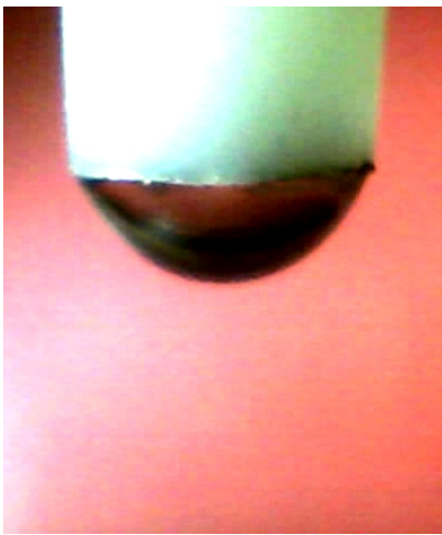
Рисунок 3 – Утворення краплі при досягненні зовнішньої кромки капіляра
