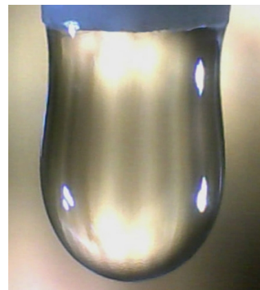
Рисунок 5 – Утворення краплі з перешийком на зовнішній кромці торця капіляру
