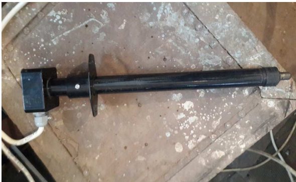
Рисунок 6 – Захисний ковпак для інсталяції кисневого зонду на різні типи котлоагрегатів
