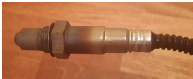
Рисунок 2 – Широкосмуговий кисневий зонд виробництва Bosch
