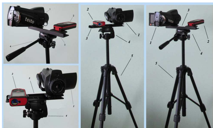
Рисунок 2 - Загальний вигляд апаратної частини комплексу тепловізійної дефектометрії
