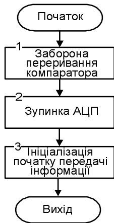
Рисунок 7 – Блок-схема підпрограми обробки переривання таймера ПППМ
