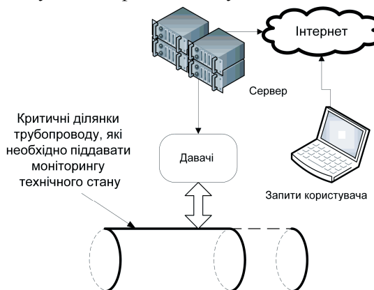
Рисунок 6 – Схема системи моніторингу технічного стану газопроводів
