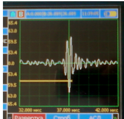
Рисунок 7 – Луно-сигнал ультразвукової спрямованої кільцевої хвилі від дефекту \varnothing 6 \times 16
