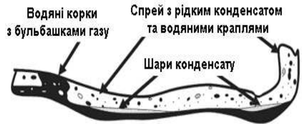
Рисунок 1 – Варіанти структури багатофазного потоку флюїду в трубопроводі свердловини
