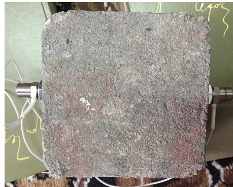
Рисунок 2 – Розташування сенсорів на дослідному взірці.
