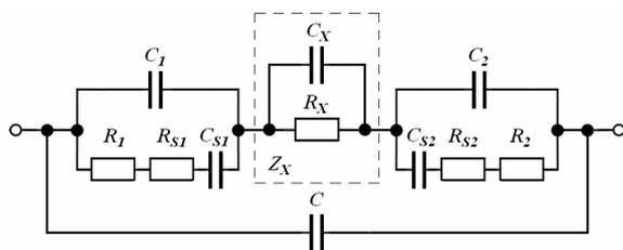
**Рисунок 6 – Заступна схема двоелектродного ємнісного сенсора**
