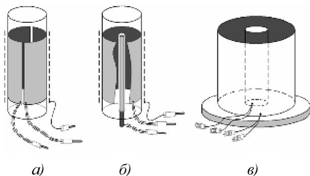
**Рисунок. 2 – Конструкції первинних перетворювачів з фіксованим об'ємом**
