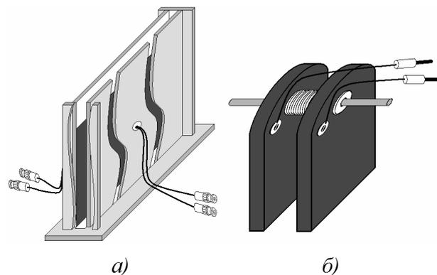
**Рисунок 3 – Конструкції первинних перетворювачів з плоскими електродами**
