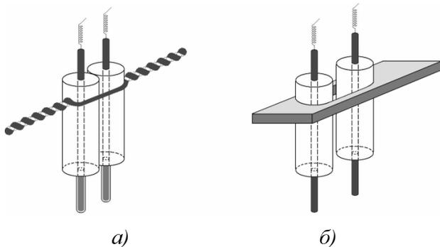
**Рисунок 1 – Конструкції первинних перетворювачів з дротяними електродами**
