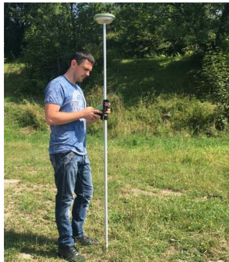
а. - Польові дослідження; б. - GPS приймач Leica GS08plus з контроллером CS10 3,5G Рисунок 4 – Проведення робіт з позиціонування трубопроводу по точках, визначених трасошукачем
