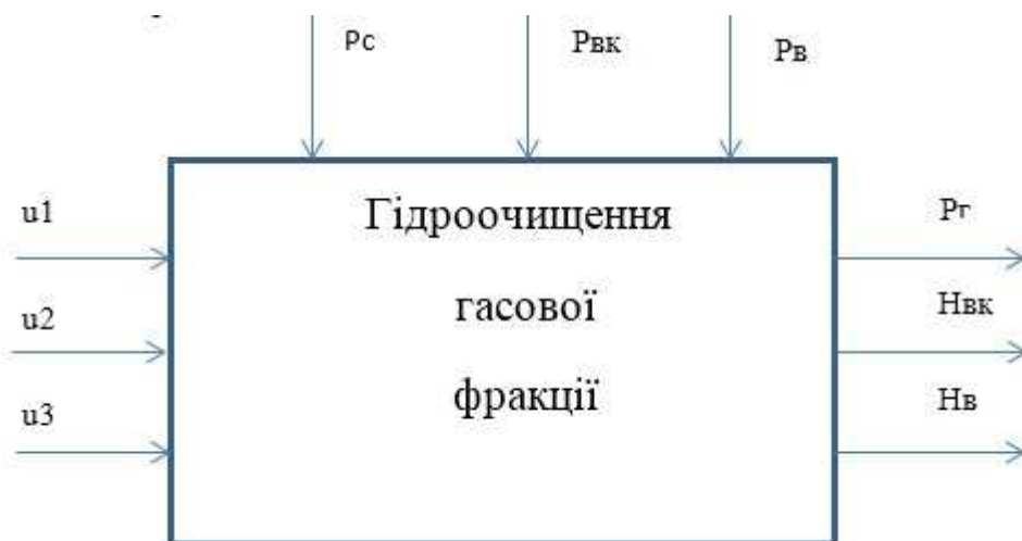
Рисунок 2 – Структурна схема процесу гідроочищення газової фракції як об'єкта автоматичного керування
