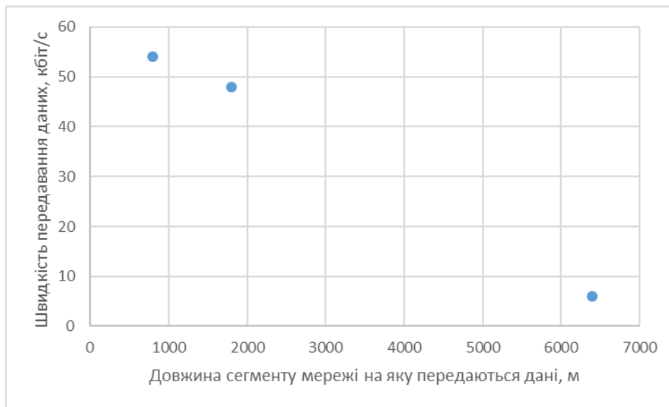
Рисунок 1 – Експериментально отримані дані про швидкість передавання даних в мережі G3-PLC на її ділянках різної довжини.
