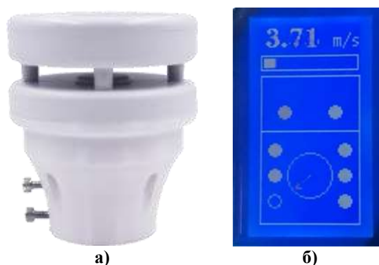
а) б) Рисунок 7 – Загальний вигляд запропонованої авторами метеорологічної станції напівавтоматичної системи аерозольного маскування (а) та інформація про метеорологічні дані, яка передається на екран пульта управління (б)
