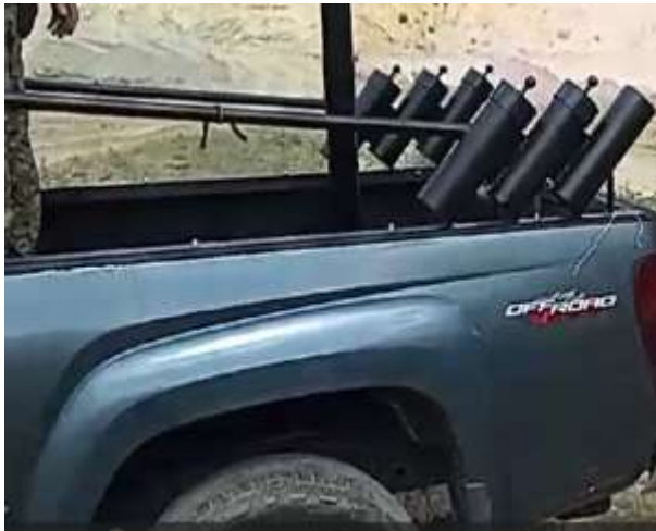
Рисунок 8 – Загальний вигляд задньої частини автомобіля із мортирами розробленої системи аерозольного маскування
