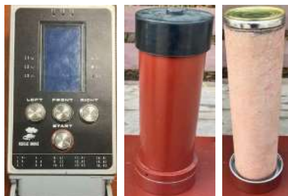
а) б) в) Рисунок 6 – Основні елементи запропонованої авторами напівавтоматичної системи аерозольного маскування: а – пульт управління системою; б – димова мортира; в – димова шашка
