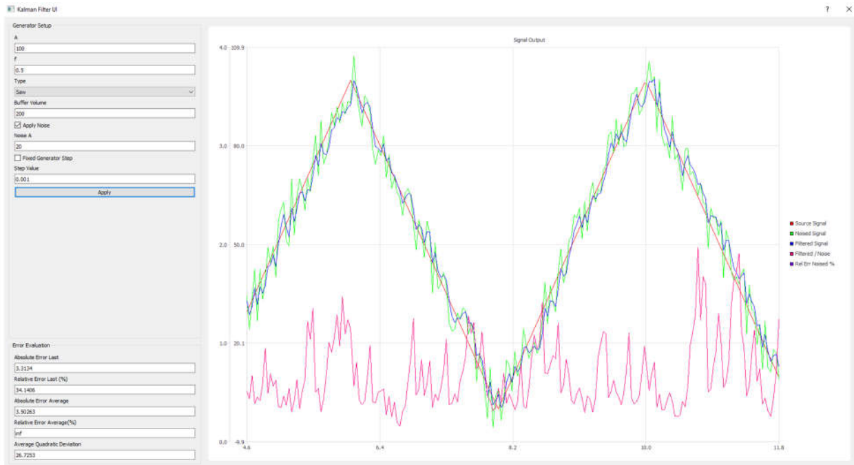
Рисунок 8 – Генерування та фільтрування трикутного сигналу
