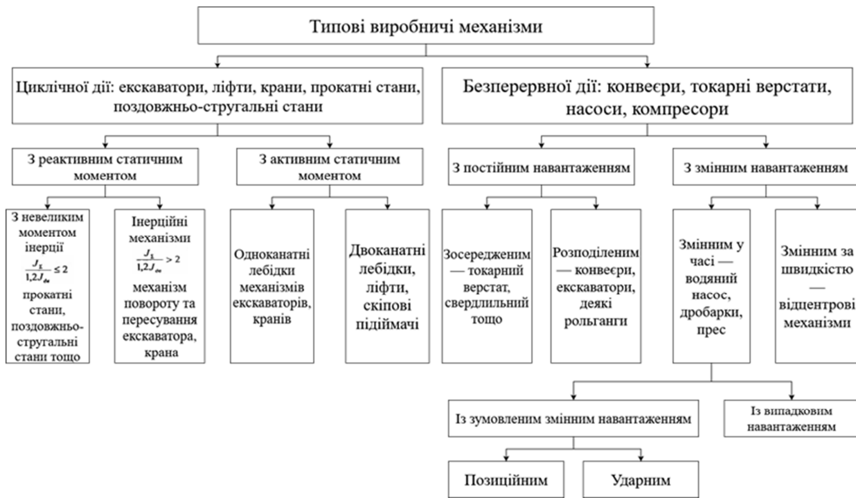
Рисунок 2 – Типові виробничі механізми в порту
