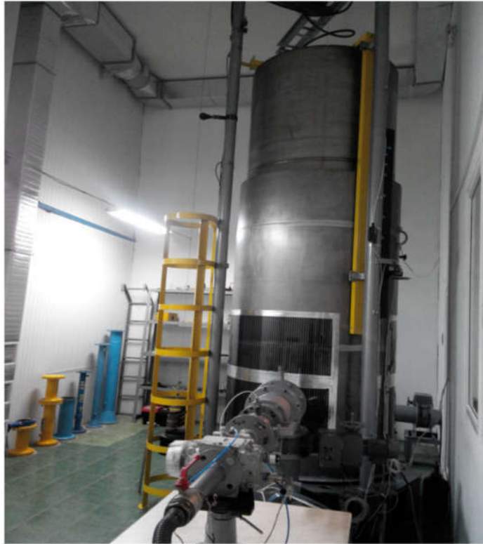
Рисунок 2 – Національний державний первинний еталон одиниць об'єму та об'ємної витрати газу ДЕТУ 03-01-15
