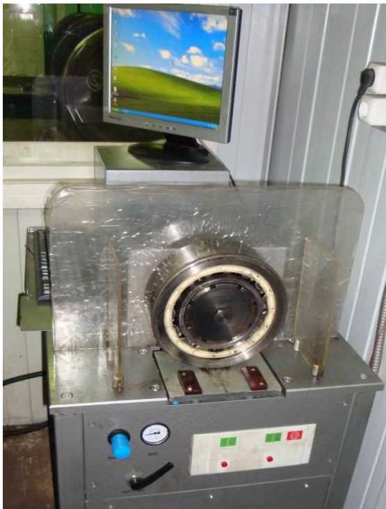
Рисунок 2 – Загальний вигляд стенда для дослідження підшипникових вузлів
