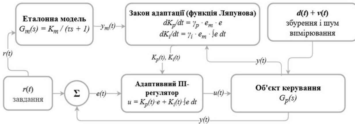
Рисунок 1 – Структурна схема адаптивної системи керування типу MRAC
