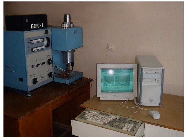
Рис. 2. Установка визначення реологічних параметрів УВРП-1
