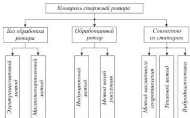
Рисунок 1 – Условия и способы контроля стержней ротора
