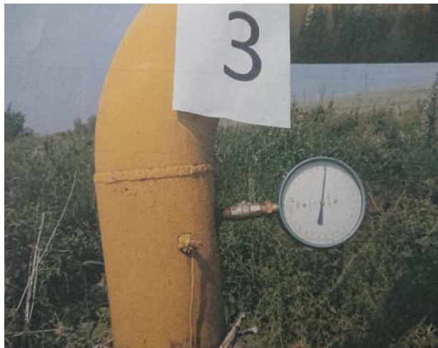
Рисунок 4 – Спосіб вимірювання параметрів мережі
