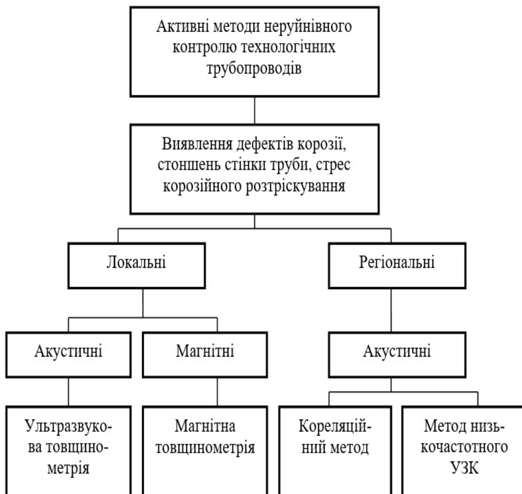
Рисунок 3 – Спрощена класифікація активних методів неруйнівного контролю технологічних трубопроводів
