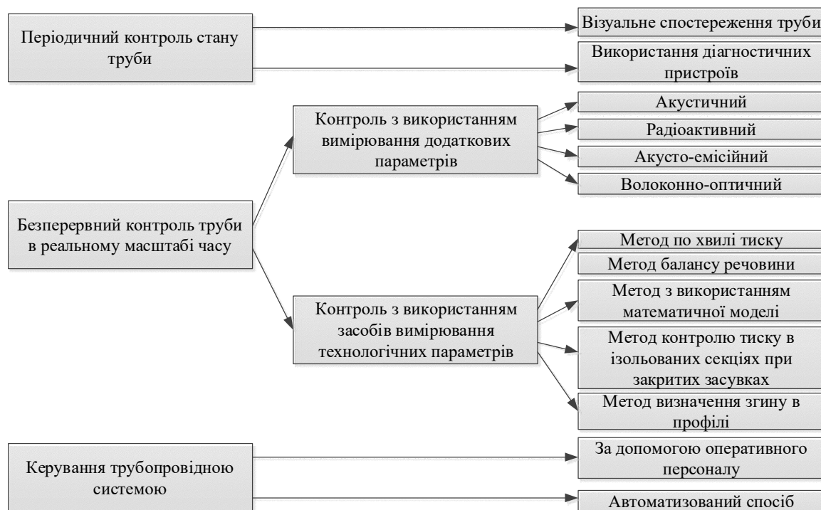
Рисунок 1 – Класифікація СМтаК за принципами дії і типам застосовуваного обладнання.
