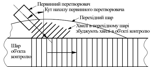
Рисунок 2 – Принцип збудження пластинчатих напрямних хвиль ультразвуковим первинним перетворювачем
