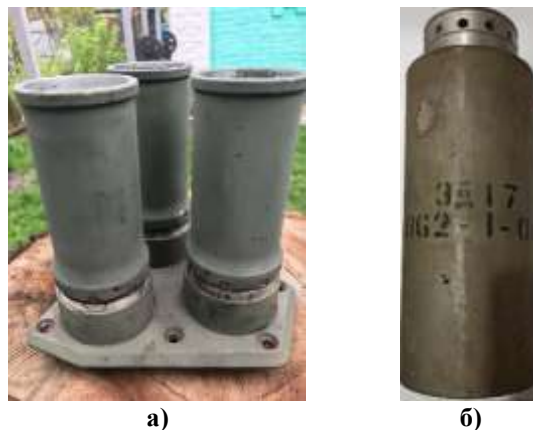
а) б) Рисунок 2 – Загальний вигляд пускових гладкоствольних стволів системи АЕК 902 «Туча» та димової гранати ЗД17
