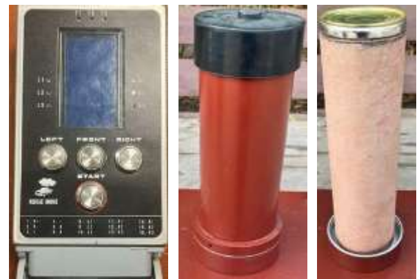
Рисунок 6 – Основні елементи запропонованої авторами напівавтоматичної системи аерозольного маскуванню: а – пульт управління системою; б – димова мортира; в – димова шашка
