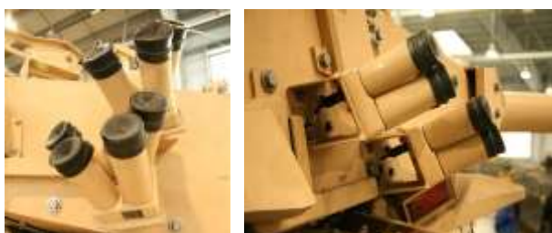
Рисунок 3 – Загальний вигляд американської системи аерозольного маскування моделі M257
