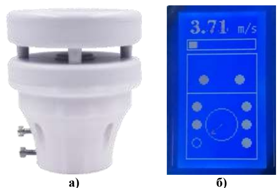
Рисунок 7 – Загальний вигляд запропонованої авторами метеорологічної станції напівавтоматичної системи аерозольного маскуванню (а) та інформація про метеорологічні дані, яка передається на екран пульта управління (б)
