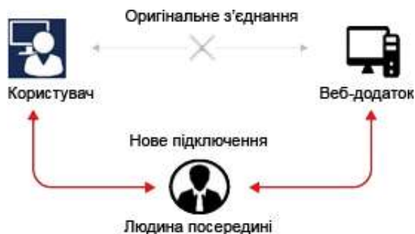
Рисунок 1 – схематичний принцип атаки типу man-in-the-middle
