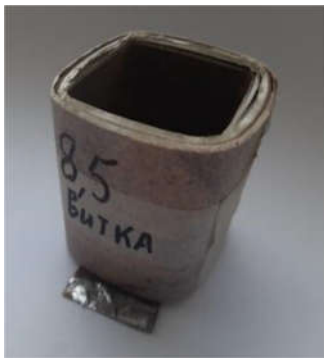
Рисунок 3 – Котушка намагнічування з мідної стрічки 60x0,5 мм 2 (8,5 витків)
