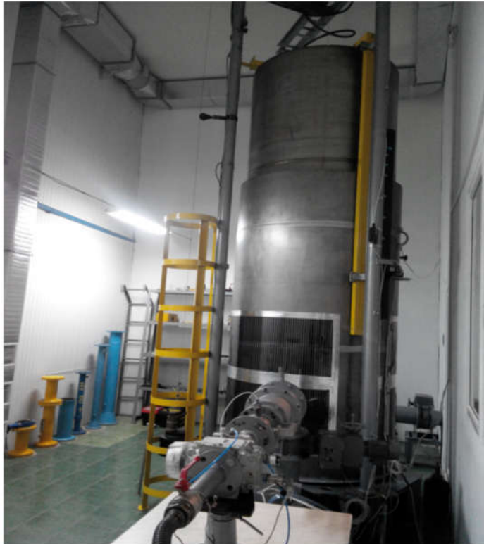
Рисунок 2 – Національний державний первинний еталон одиниць об'єму та об'ємної витрати газу ДЕГУ 03-01-15
