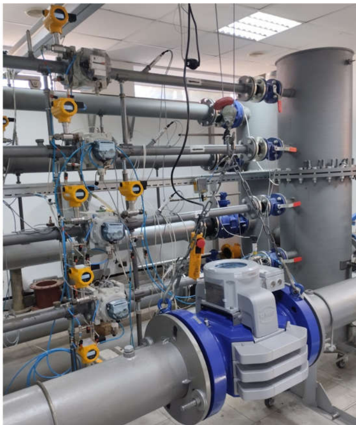
Рисунок 3 – Процес градуювання ультразвукового лічильника газу із застосуванням вторинних еталонів одиниць об'єму та об'ємної витрати газу ВЕТУ 03-01-03-11 та ВЕТУ 03-01-04-12
