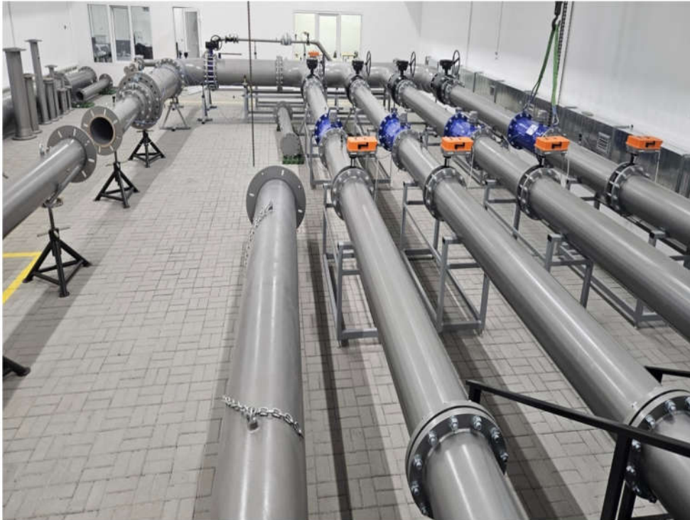
Рисунок 4 – Еталонна установка одиниць об'єму та об'ємної витрати газу Stand-25000 в діапазоні об'ємної витрати від 1 м 3 /год до 25000 м 3 /год
